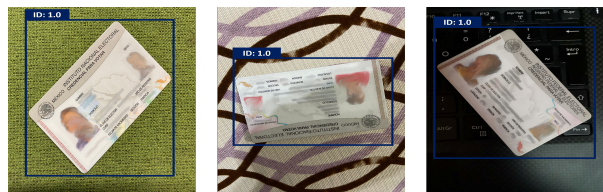
Fig. 2. YOLOv4 localiza y clasifica el objeto de interés contenido en la imagen. En estos ejemplos, se observa que los IDs localizados y delimitados mediante bounding boxes, han sido categorizados en la clase ID, con una precisión del 1.0 (100 %).
